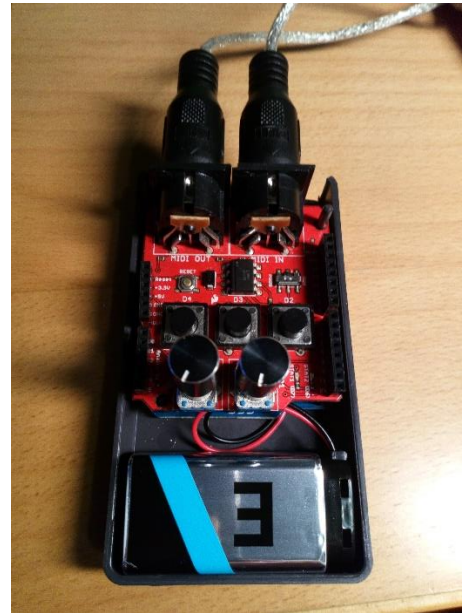
Arduino + BLE + MIDI (running MIDISmart.ino)
